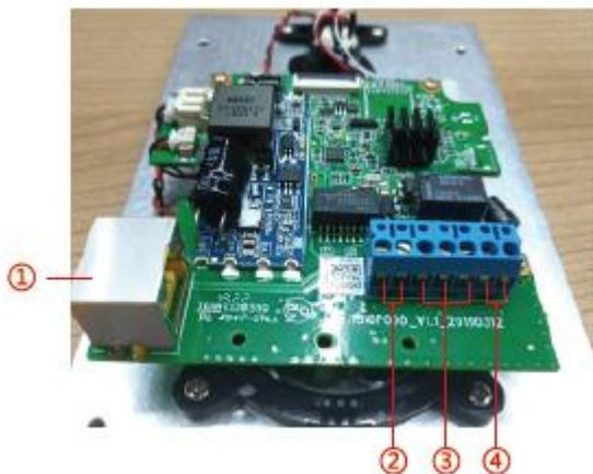
1. Интерфейс Ethernet: стандартный интерфейс RJ45, адаптивный 10/100 М, рекомендуется использовать сетевой кабель Cat5 или выше
